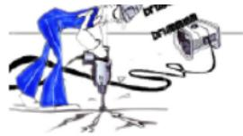
Un **grupo electrógeno** es una máquina concebida para suministrar energía eléctrica en obras o puntos en los que no se puede tener acceso a la red comercial.
